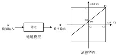
设置通道特性的目的是为了调整模块的现场线性误差, 由于模块使用环境温度的不同及使用连接电缆的原因, 会给测量结果带来误差, 用户可以通过设定通道特性来消除此类误差。
